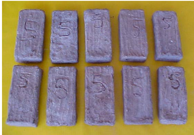
Figura 4 - Tijolos com inóculos de 5% de Egeria densa
