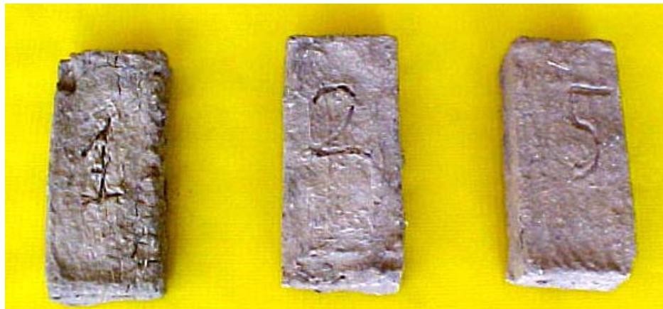
Figura 3 - Tijolos com 1, 2 e 5% de Egeria densa em sua composição.
