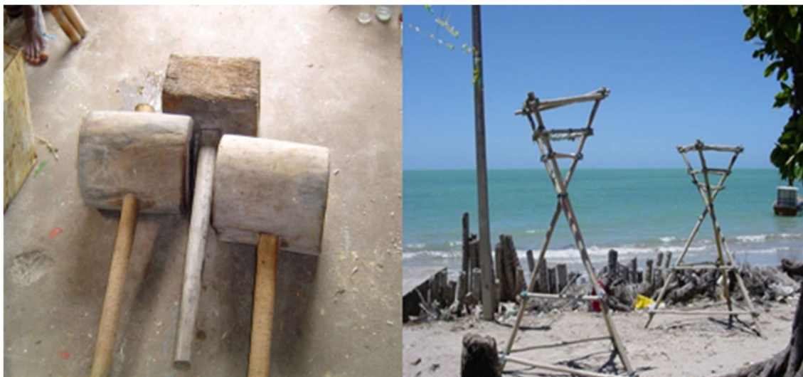
Figura 5. O malho é uma marreta utilizada para cravar os mourões (esquerda). O jacumã é uma estrutura de madeira que estabilizar os pescadores para bater os mourões (direita). Fonte: Arley Pereira.
